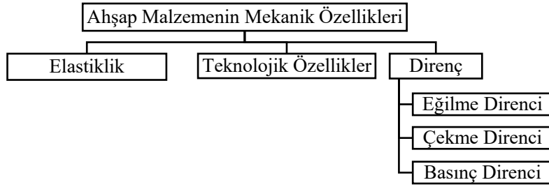
Şekil 2: Ahşap malzemenin mekanik özelliklerinin sınıflandırılması.
